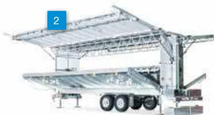
Déploiement hydraulique des panneaux du toit et du plancher.
