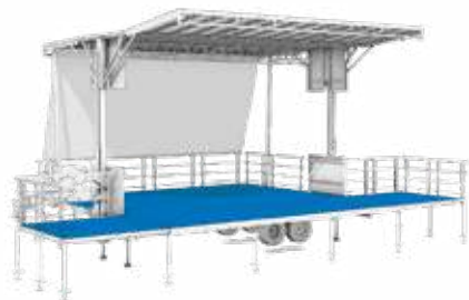
Scène avec extension arrière de 1 m x 7 m (4 pi x 24 pi) et coulisses pour l'équipement sonore de 2,5 m x 2,5 m (8 pi x 8 pi)
