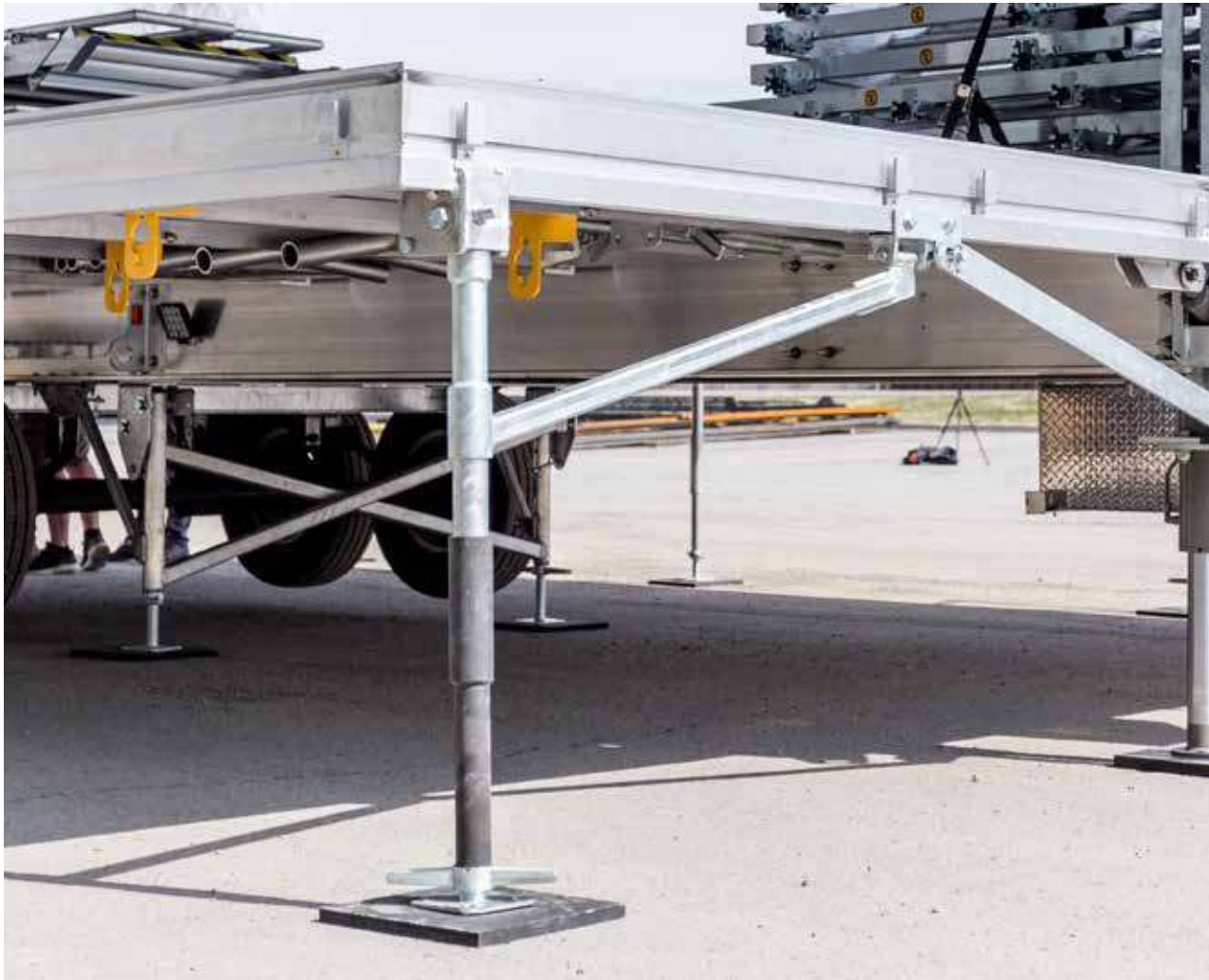
La plate-forme et le châssis, conçus pour résister à des charges de 732 kg/m 2 (150 lb/ft 2 ), sont conformes aux normes de l'IBC et du CNB Ajout de renforts en acier aux tiges portantes sous la partie intermédiaire du châssis de la remorque.
